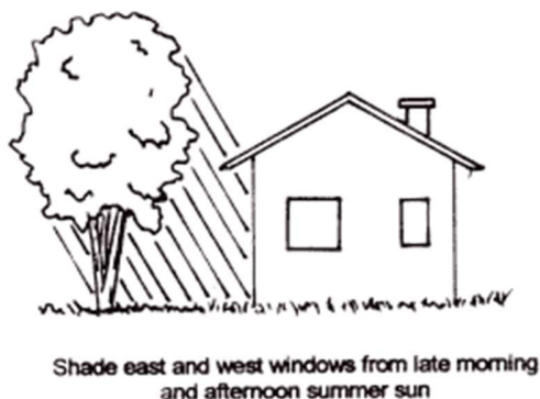
Slika 31: Primer zaščite objekta pred soncem
