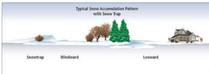
Slika 30. Značilen vzorec kopičenja snega z zasajenim grmičjem v funkciji snežne ovire
